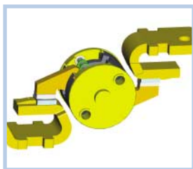
Оптимизированная форма эксцентрика
