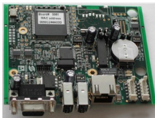
Плата ES851 DataLogger представляет собой опциональную плату, обеспечивающую сбор данных о параметрах системы и передачу их на контролирующей компьютер, даже удаленный.
