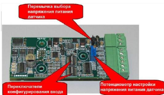
Плата для инкрементного реверсивного датчика, используемого в качестве источника обратной связи для преобразователей серий OptiCor P. Позволяет подключать датчики с питанием +5...15 В или 24 В (настраиваемое) с выходами line driver.
