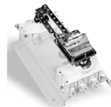
Механизм переключения позволяет собрать из двух выключателей разъединитель переключатель на два направления. Имеет три положения рукоятки I – O – II
