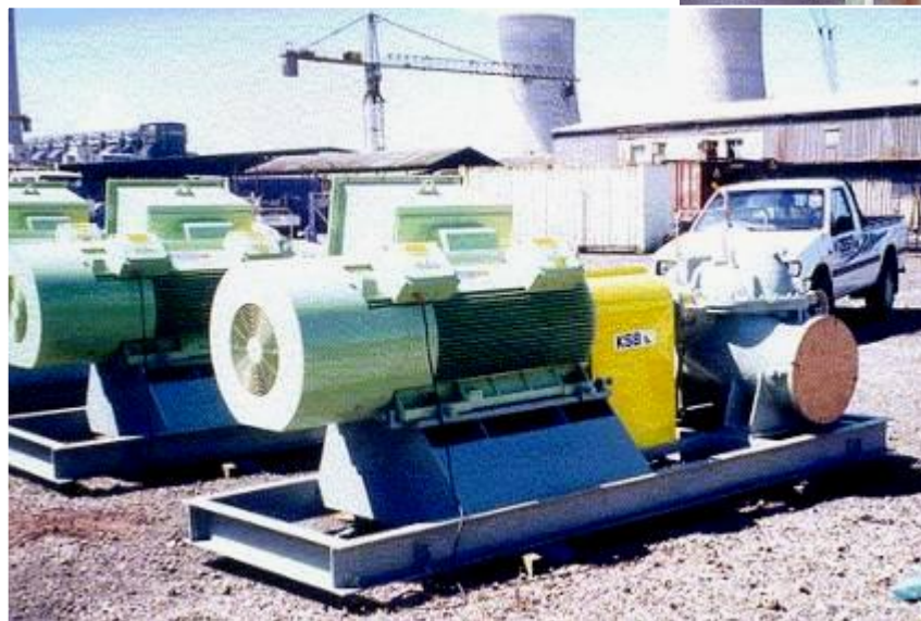
5 x 180 кВт, 4 пол., 6.6 кВ 50 Гц HGF315, асинхронные двигатели Готовы к установке Применение: насосы KSB на нефтеперерабатывающем заводе SASOL ▼ Южная африка
