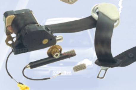
Металлическая подушка в системе натяга ремней безопасности. Смягчает сопутствующие негативные последствия взрыва пиропатрона
